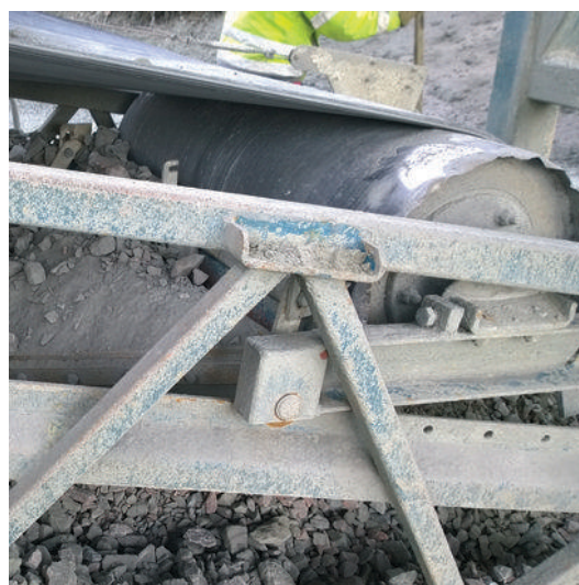
Bild 9: Ansamling av material kring vändtrumma
