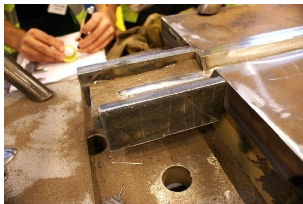
Figur 8: Stoppbit som efter gjord svetsning kapas bort.
