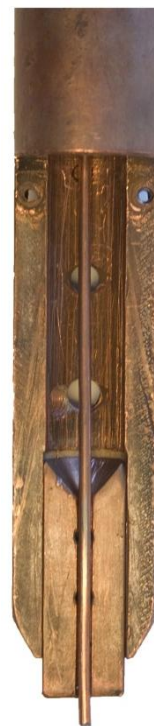
Figur 4: Den större halvan av ett svetsrör med en singelback monterad.
