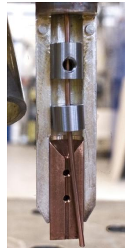
Figur 23: Trådens böjning från rullen gör att även om den leds ned på rätt ställe så hamnar den fel. Vår kuts är den närmast backen.
