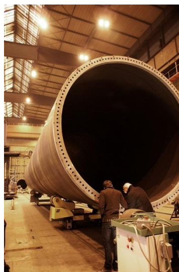
Figur 15: Bilden visar en sektion av ett vindkraftstorn. Svetskranen skymtar till vänster i bakgrunden.
