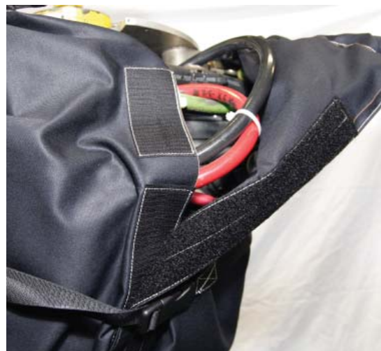
Figur 17. Kardborren som fäster ihop den längsgående öppningen.
