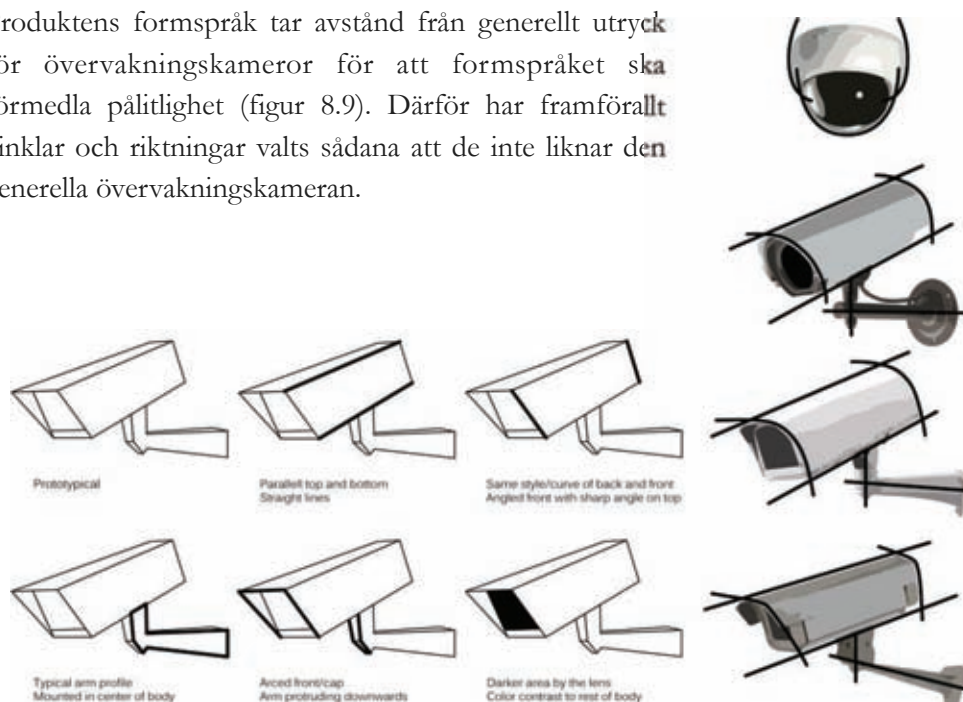
Figur 8.9. Generellt formspråk för övervakningskameror
