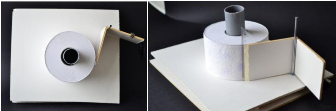
Figur 24. Funktionalitetstest med hjälp av mock-up av koncept 4.4.1 Jumborulle med spärr
