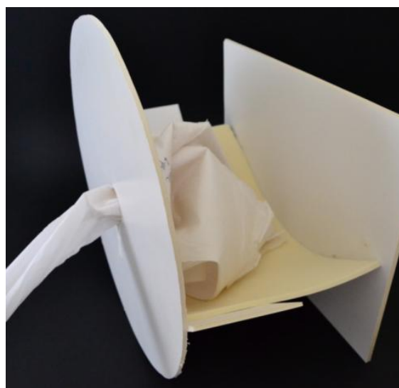
Figur 25. Stockning i utloppet av kollapsat papper
