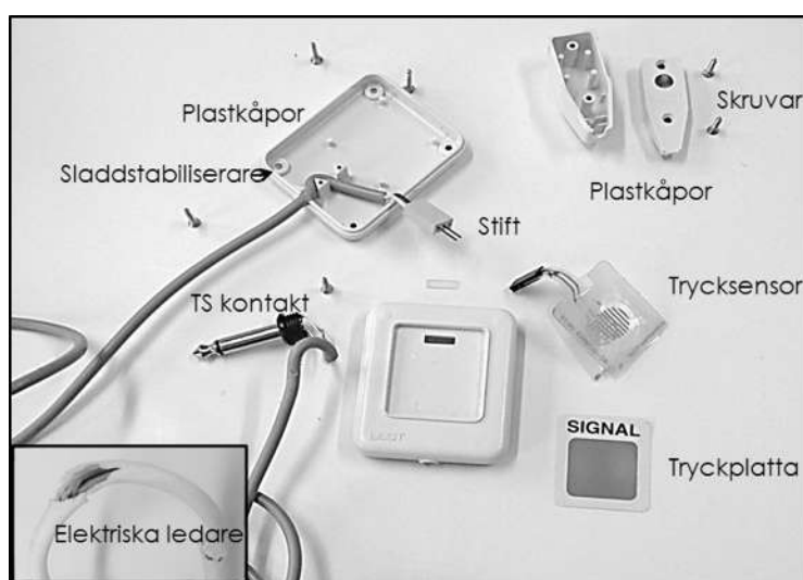
Figur 2.5 Översiktsbild av larmdosans alla komponenter
