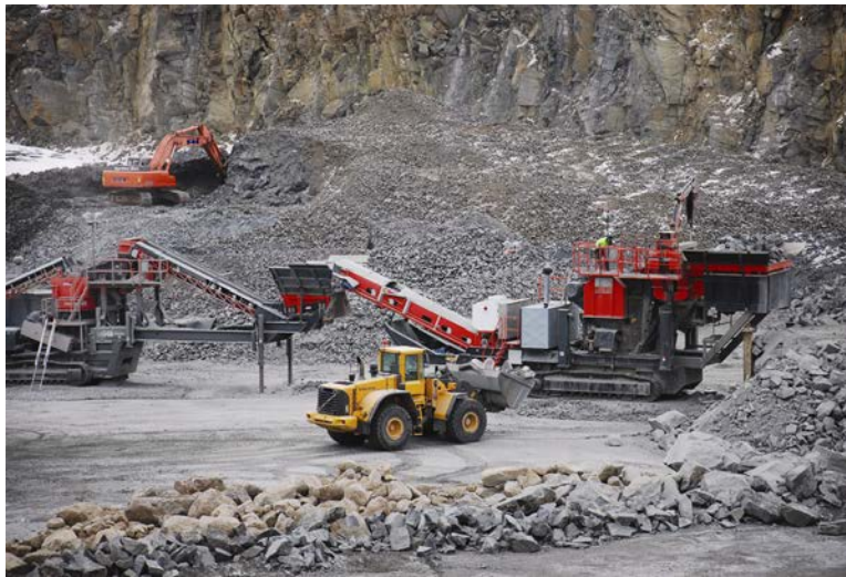
Figur1.1:2 – Bergtäkt med sammankopplad mobil för- och efterkross, lastmaskin och grävmaskin
