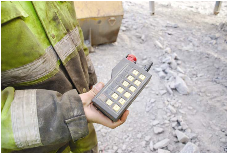
Figur 6.3.2:1 - En befintlig fjärrkontroll med anläggningsstopp, fotograferad under besök på arbetsplats
