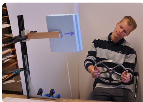
Figur 19. Koncept Gångjärn (till vänster) monterad på vertikal E-profil, riktning på monitor utmarkerad med blå pil.
