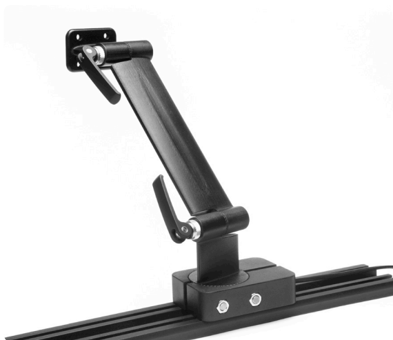
Figur 30. Foto av funktionsmodell med spännare i låst läge
