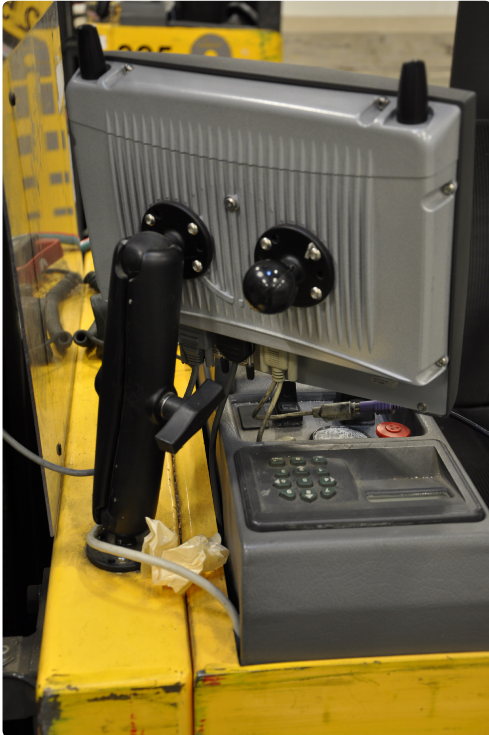
Figur 2. Nuvarande tillbehörsfäste, monterad på en truck ; tillbehöret är förberett för två fästen.
