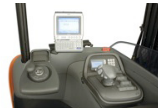
Figur 35. PC monterad i en BT Reflex Truck
