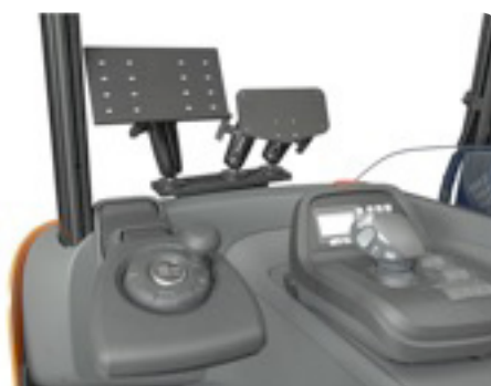
Figur 35. PC monterad i en BT Reflex Truck
