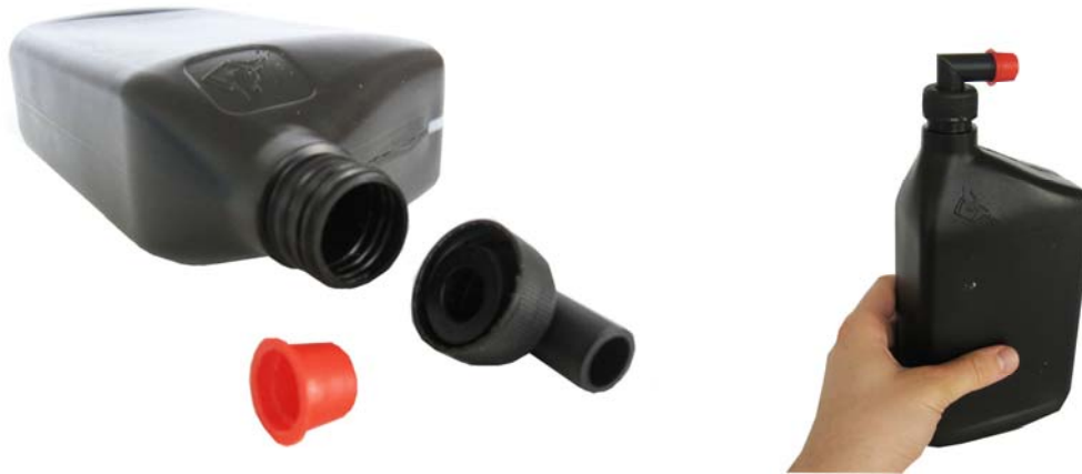
Bild 8.1.5: Prototyp för korkarnas konstruktion. För att bygga prototypen användes ett smalt rör av plast med en utsvarvad klack. Röret sågades av på mitten och genom att borra ett hål i korken till den svarta behållaren på bilden, kunde de två rördelarna limmas fast. Då korken inte var påskruvad kunde det böjda röret röras fritt, men då korken skruvades åt fastnade röret i valt läge. Den röda detaljen på bilden användes som en kork till det böjda röret.
