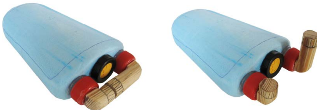
Bild 8.2: Konceptval. Ovan syns en bild på en prototyp av det valda konceptet. Den svarta, cylindriska formen med en gul knapp visar var indikatorn kommer att placeras. Som syns på bilderna kan korkarna skruvas fast så att röret riktas åt olika håll, vilket medger flexibilitet vid påfyllning.
