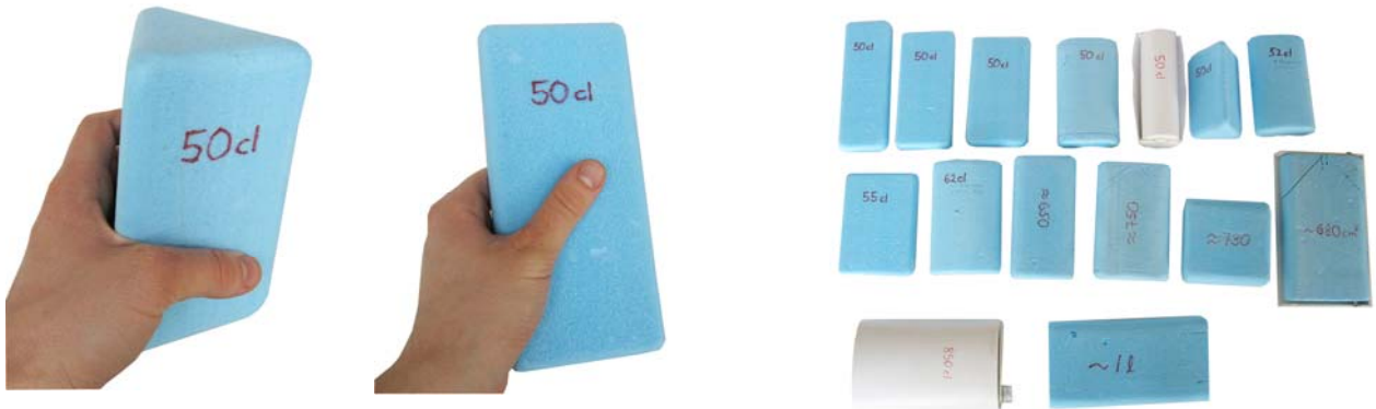
Bild 8.1.1.2.2a: Volym- och formprototyper. Volymer mellan 0,5 – 1 liter testades i olika utformningar. På bilderna ovan visas två närbilder och en samlingsbild med utvalda modeller. Prototyperna på bilderna användes under volym- och formundersökningen.
