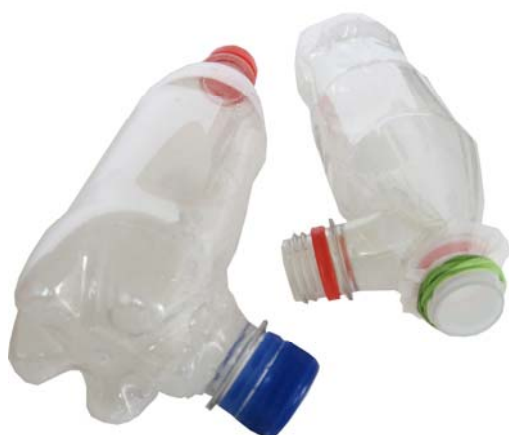
Bild 8.1.1.2.1: Prototypmodeller av koncept B. Ovan visas två modeller av koncept B, där de två öppningarna har placerats på olika avstånd relativt varandra.
