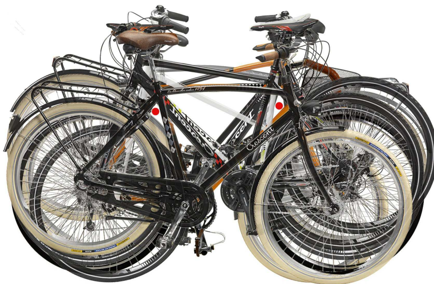
Figur 19. Illustration av att fästpunkterna (rödmarkerade) passar för ett stort antal cykelmodeller
