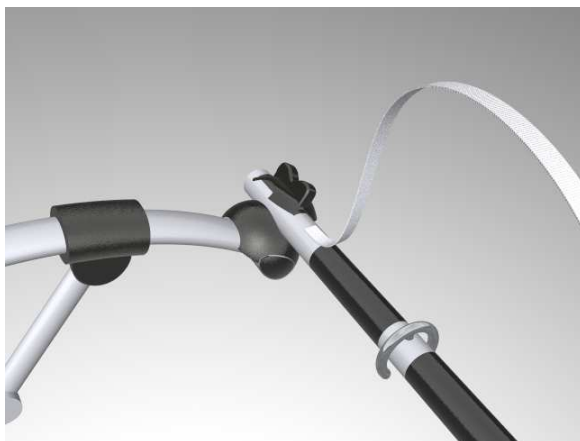
Figur 43. Låsleden i monterat läge sett från sidan
