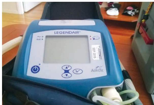
Figur 20 — Respirator med ljussvag display som är svår att läsa av i solsken
